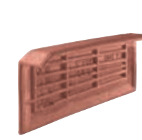
Rive individuelle gauche à recouvrement (2,7 par ml au pureau de 375 mm) Réf. 200.42 (2)
