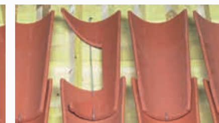
Fixation des tuiles de courant en plain carré par crochets longs à œil à raison, sur 10 crochets 2 crochets longs à œil - Réf. CRCAN.550
