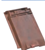
Tuile de ventilation Castel (section avec grille = 24 cm 2 ) Réf. 201.20
