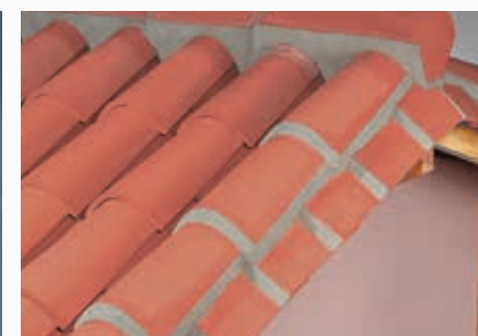
Fixation des bardis droit 20x30, scellés au mortier correspondant aux prescriptions du DTU.40.22 amendement A2 art. 2.4. Cette mise en œuvre peut s'effectuer sur support continu ou sur liteaux mais nécessite l'établissement d'un support continu au droit des rives.
