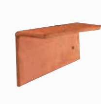
Rive individuelle gauche pour 16 x 24 Phalempin (6 par ml au pureau de 85 mm) Réf. 505.44
