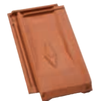
Tuile de ventilation Losangée Ste Foy (section avec grille = 19 cm²) Réf. 228.20
