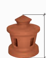
Lanterne Ø 126 utile (section d'aération : 140 cm 2 ) Réf. 1011
