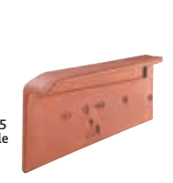
Rive individuelle gauche à recouvrement (2,7 par ml au pureau de 368 mm) Réf. 215.42 (2)
