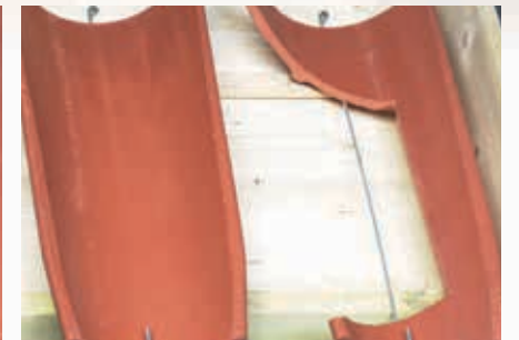
Fixation des tuiles de courant à tenons du 1 er rang d'égout, en rives latérales gauche et droite par crochets longs à œil. Réf. CRCAN.550. La fixation des crochets s'effectue facilement sur le support ou sur les chevrons.
