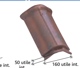
Faîtière/arêtier grand modèle à emboîtement (3 au ml) Réf. 706 Crochet adapté : crochet F6-Réf. CRP 700/706
