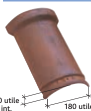
Faîtière/arêtier 1/2 rond à emboîtement petit modèle (3 au ml) Réf. 700 Crochet adapté : crochet F6-Réf. CRP 700/706
