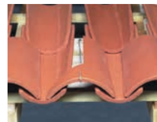
Fixation des tuiles de couvert du 1 er rang d'égout, par crochets longs à œil. Réf. CRCAN.550
