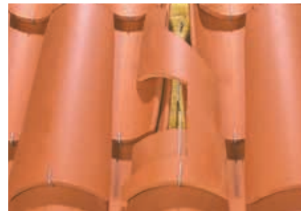
Fixation des tuiles de couvert en plain carré par crochets longs à œil cambré à raison, sur 10 crochets : 2 crochets longs à œil cambrés. Réf. CRCAN.530
