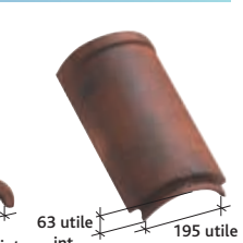
Faîtière/arêtier 1/2 rond à emboîtement grand modèle (2,5 au ml) Réf. 702 Crochet adapté : crochet F1-Réf. CRP 702
