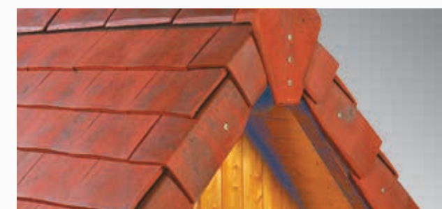
Emploi des rives individuelles gauches et droites. Fixation du fronton par vis et rondelle d'étanchéité.
