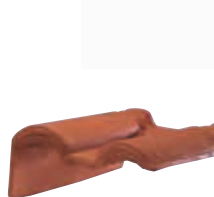
Tuile de rive à rabat gauche à recouvrement 2/3 pureau Médionale (4 par ml au pureau de 250 mm) Réf. 102.75
